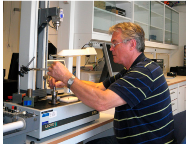
Mynd 5. Erik Kleven, tækja- og þúsundjalasmiður, aðstoðar höfundur við endurbætur aðferða við mikró togþolspróf.
